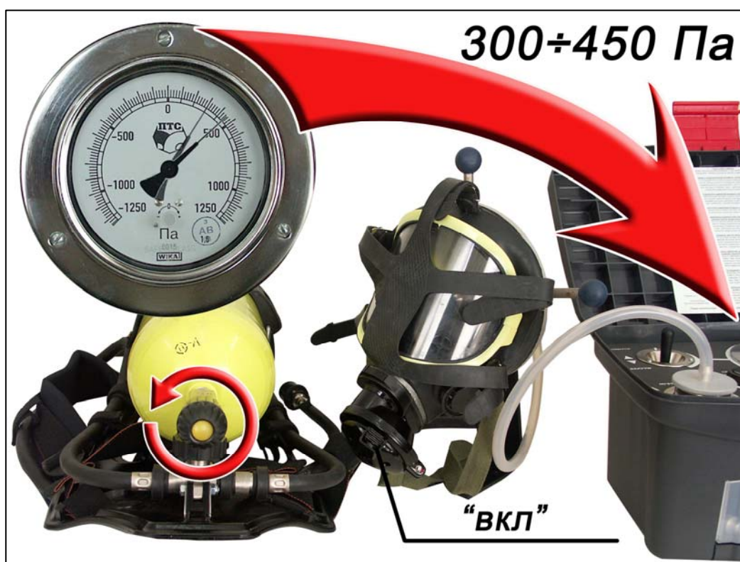
Рис. 2.29. Проверка исправности легочного автомата газодымозащитника
