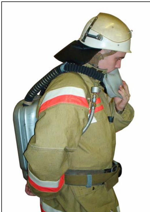
Рис. 2.69. Проверка работы легочного автомата
