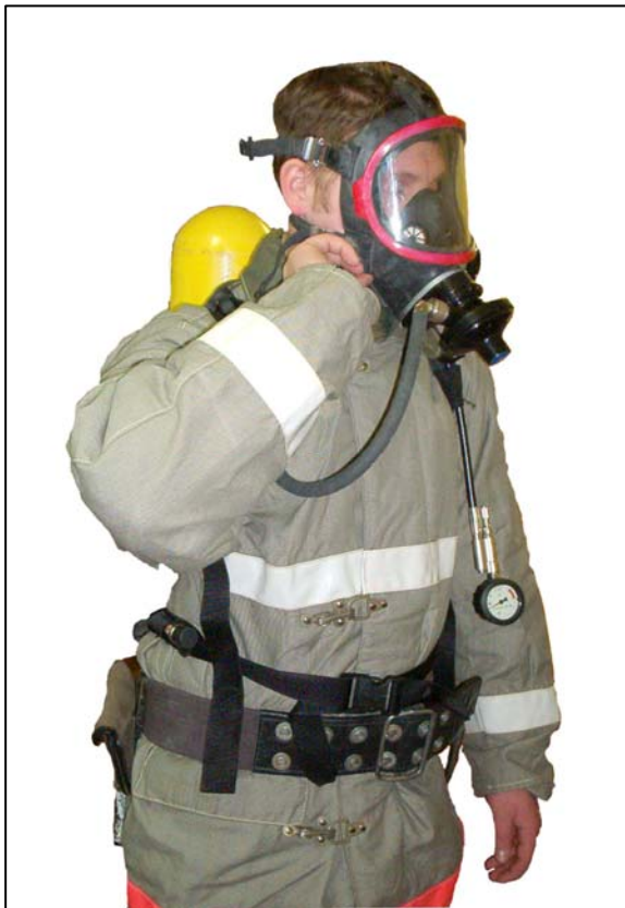
Рис.2.90. Проверка наличия постоянного потока воздуха
