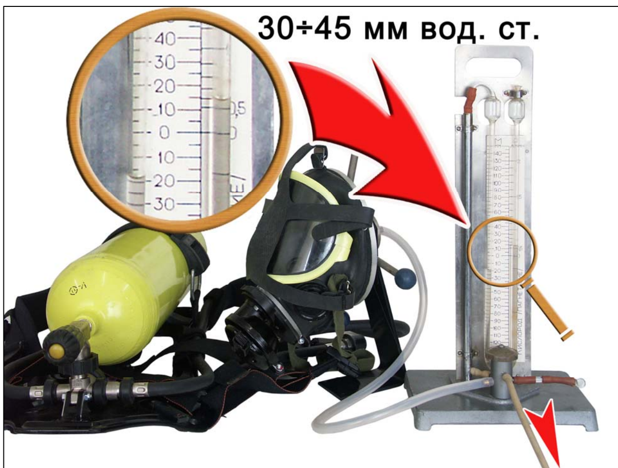
Рис. 2.34. Проверка подмасочного давления
