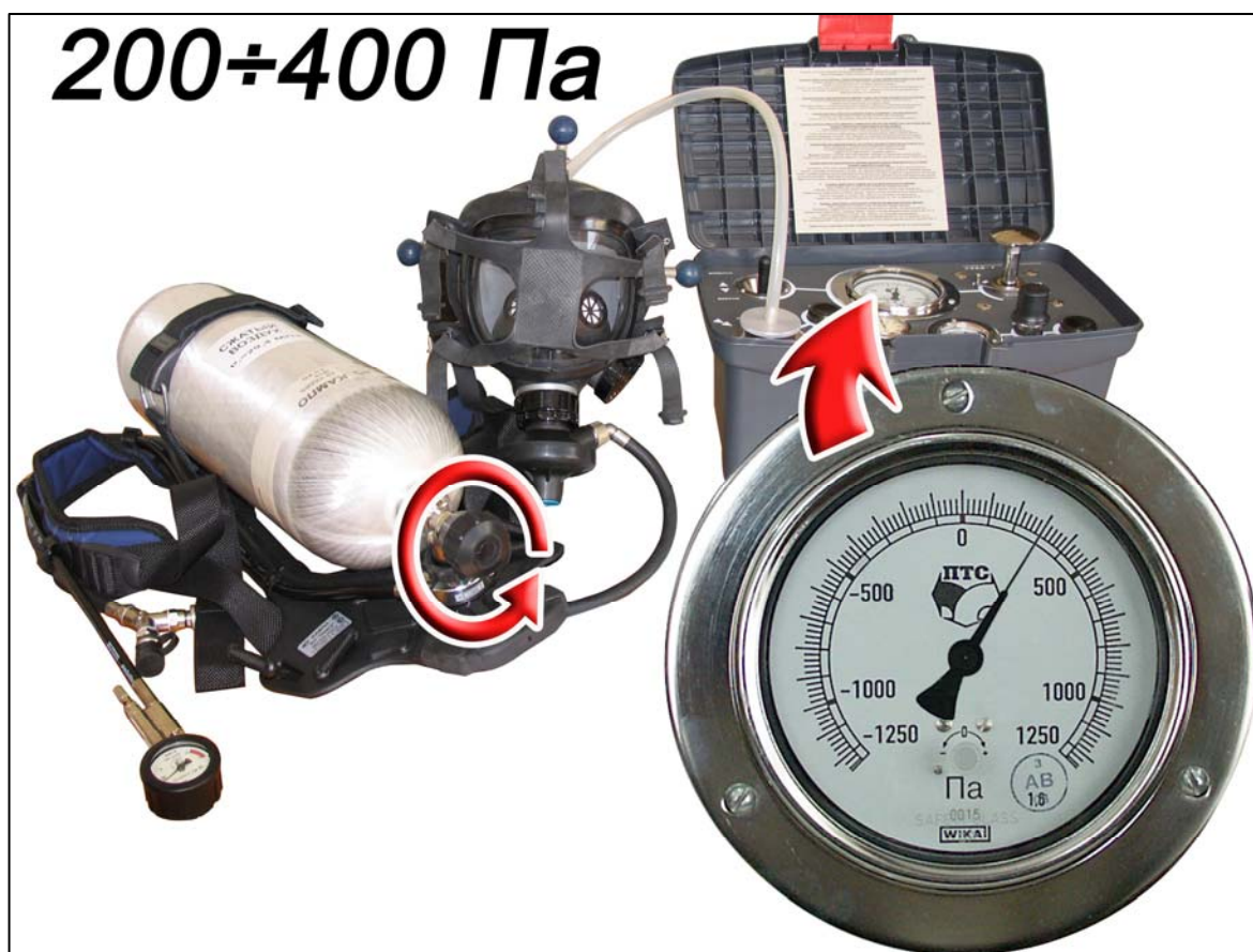
Рис. 2.50. Проверка исправности легочного автомата газодымозащитника
