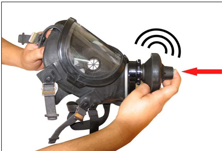
Рис. 2.52. Проверка устройства дополнительной подачи воздуха
