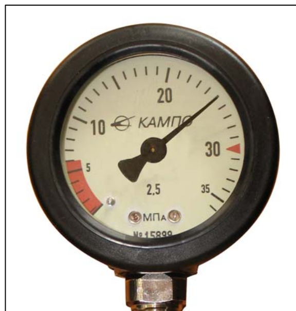
Рис. 2.55. Проверка давления в баллоне
