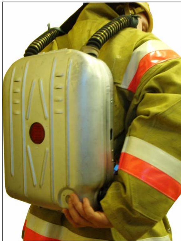
Рис. 2.70. Проверка работы аварийной подачи.
