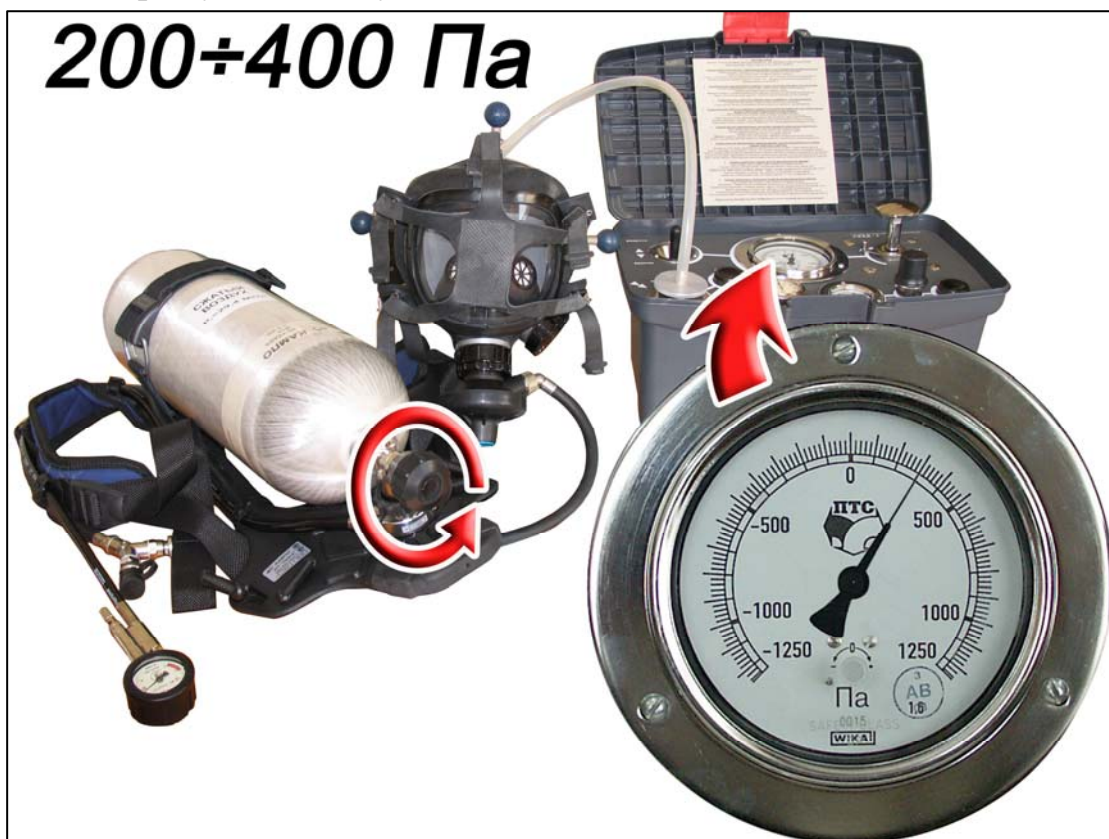
Рис. 2.43. Проверка подмасочного давления
