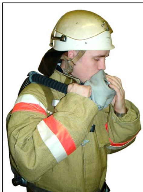
Рис. 2.66. Проверка герметичности клапана выдоха
