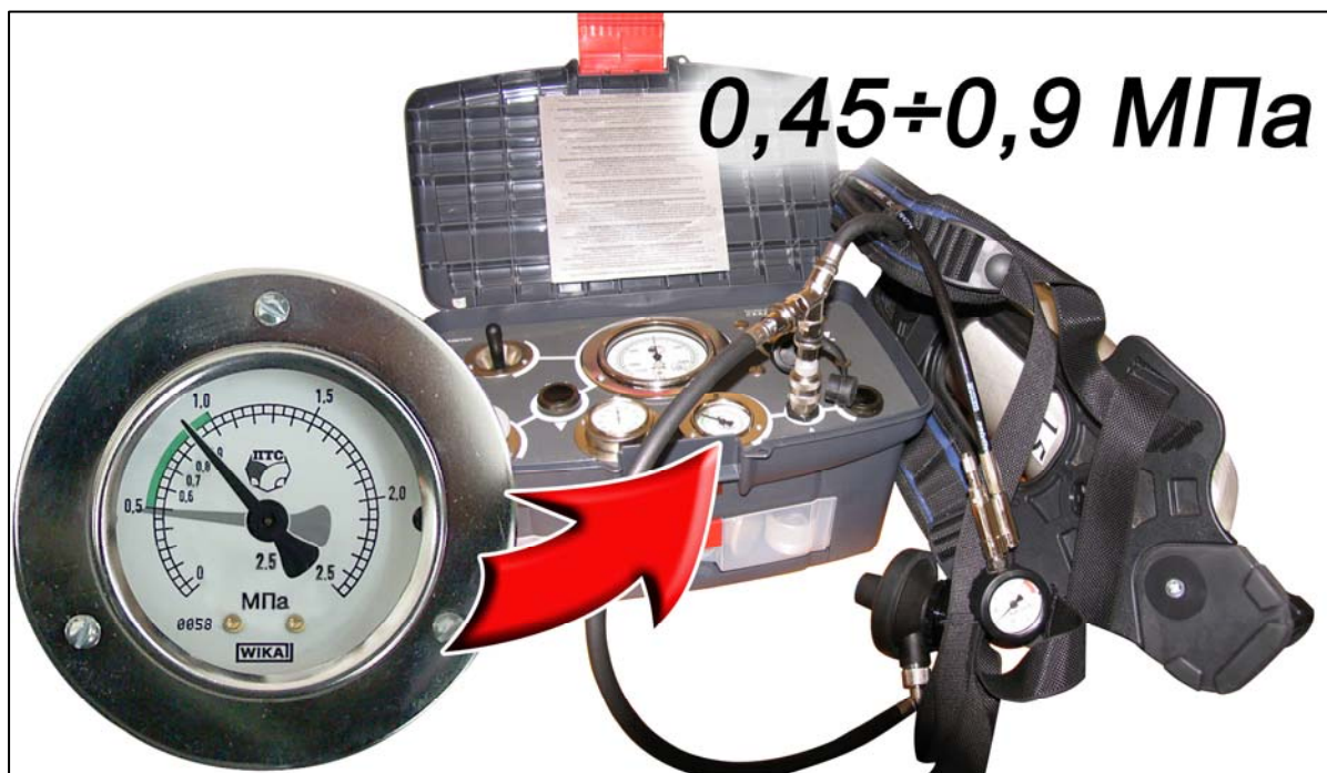
Рис. 2.54. Проверка исправности газового редуктора
