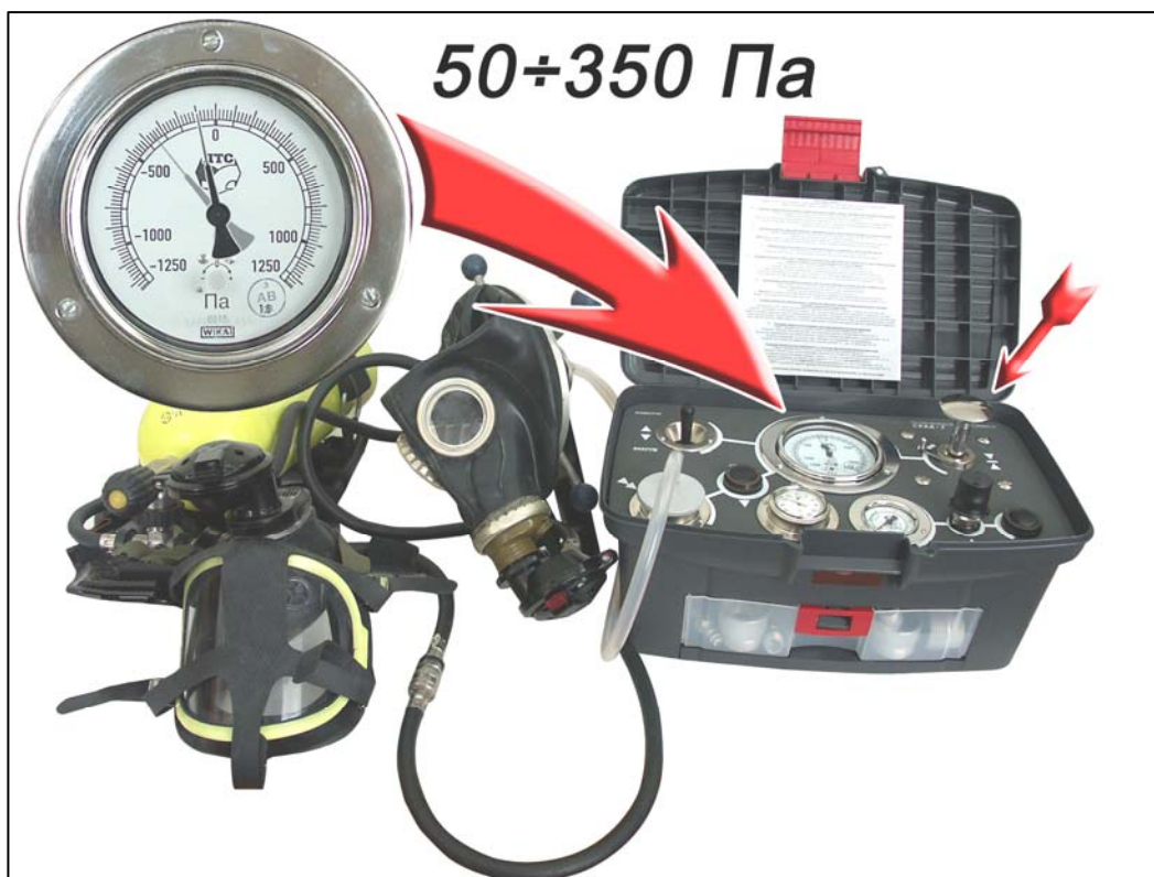
Рис. 2.30. Проверка исправности легочного автомата спасательного устройства
