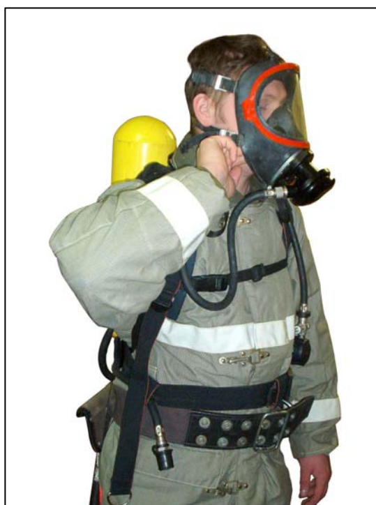
Рис. 2.78. Проверка наличия постоянного потока воздуха
