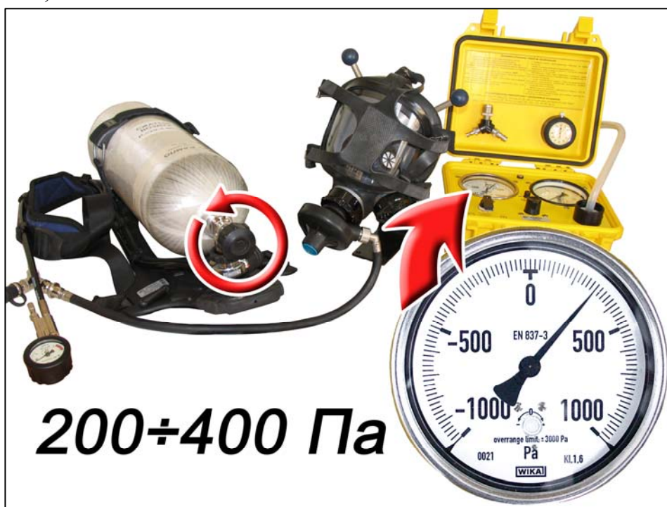
Рис. 2.60. Проверка исправности легочного автомата газодымозащитника
