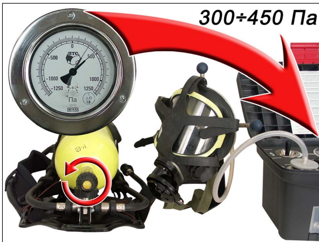
Рис. 2.23. Проверка механизма подмасочного давления
