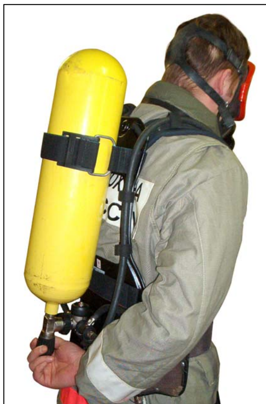
Рис. 2.77. Открытие ventилья баллона
