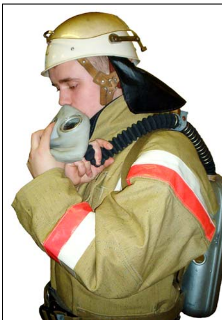
Рис. 2.65. Проверка герметичности клапана вдоха
