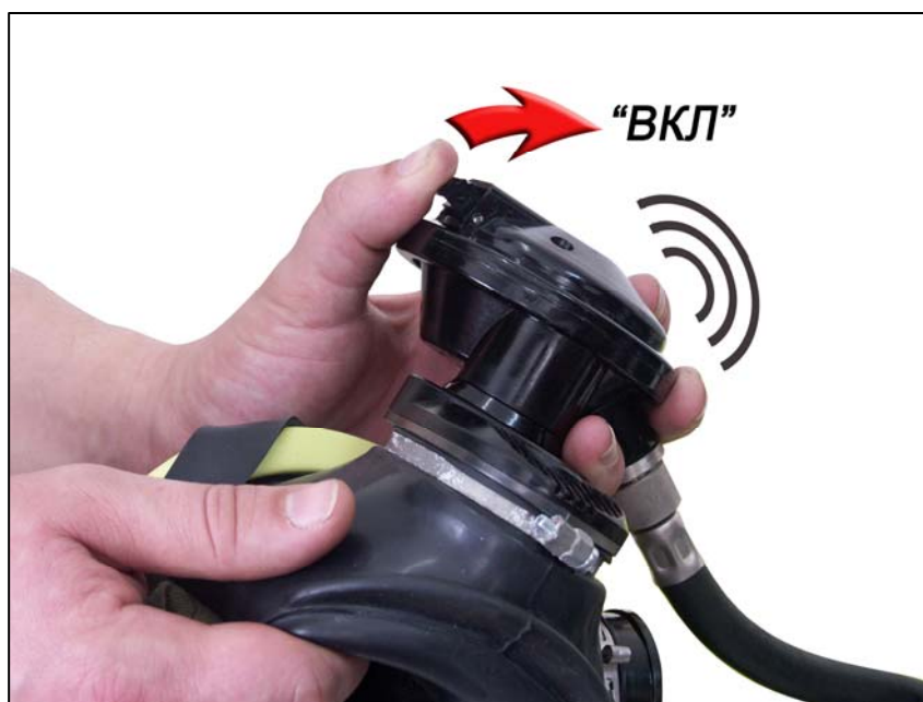
Рис. 2.31. Проверка устройства дополнительной подачи воздуха
