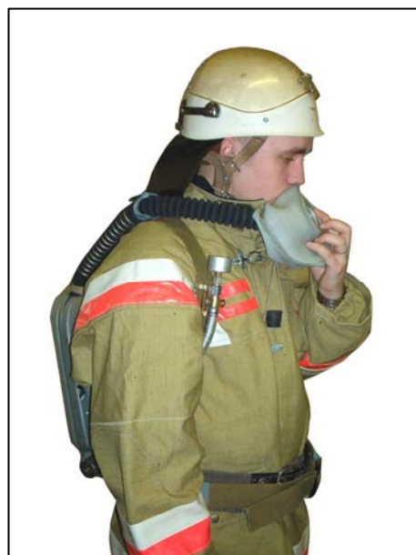
Рис. 2.67. Проверка герметичности на разрежение.
