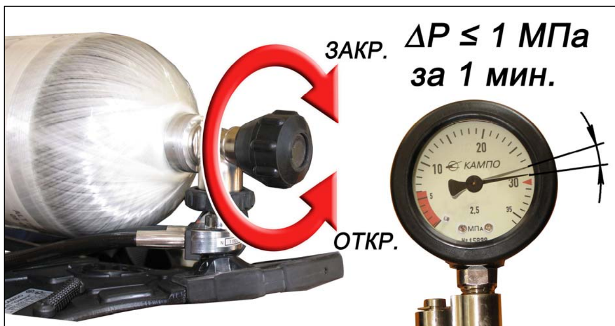
Рис. 2.46. Проверка герметичности системы высокого и редуцированного давления со спасательным устройством
