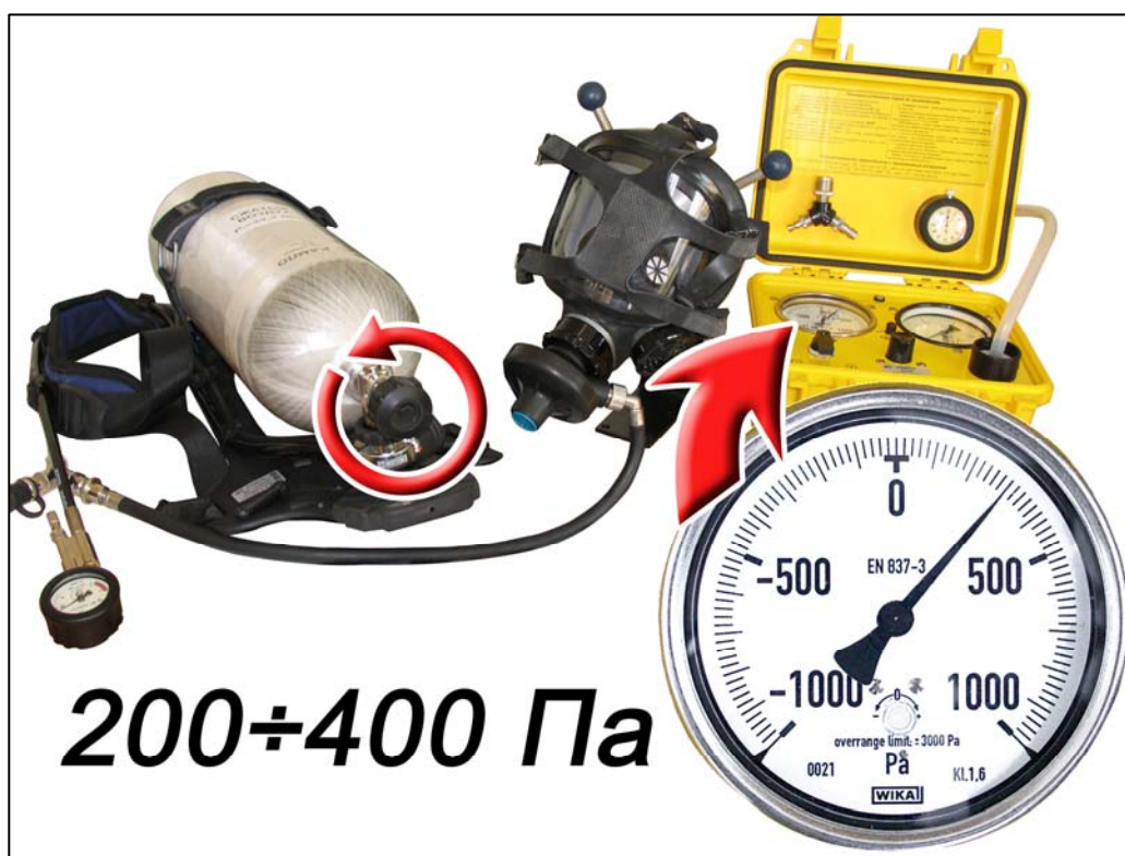
Рис. 2.56. Проверка подмасочного давления
