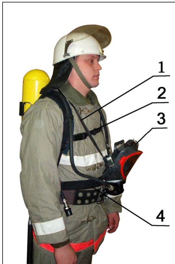
Рис. 2.74. Исходное положение правой, если она полностью укомплектована и отсутствуют повреждения её элементов. Проверяют отсутствие повреждений элементов маски, наличие дыхательных клапанов, зажатие панорамного стекла обоймой и соединительной коробки хомутом, плотность крепления легочного автомата в патрубке соединительной коробки маски (Рис. 2.75).
