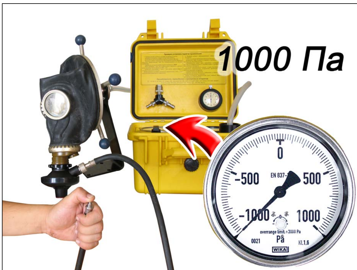
Рис. 2.59. Проверка герметичности спасательного устройства
